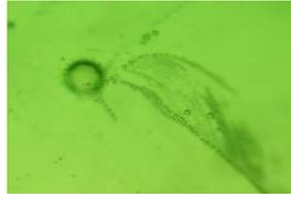
**Figure 12.** Bulle d'air dans le verre fabriqué [21]
