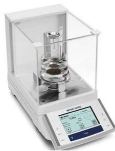
**Figure 16.** Balance hydrostatique [13]
