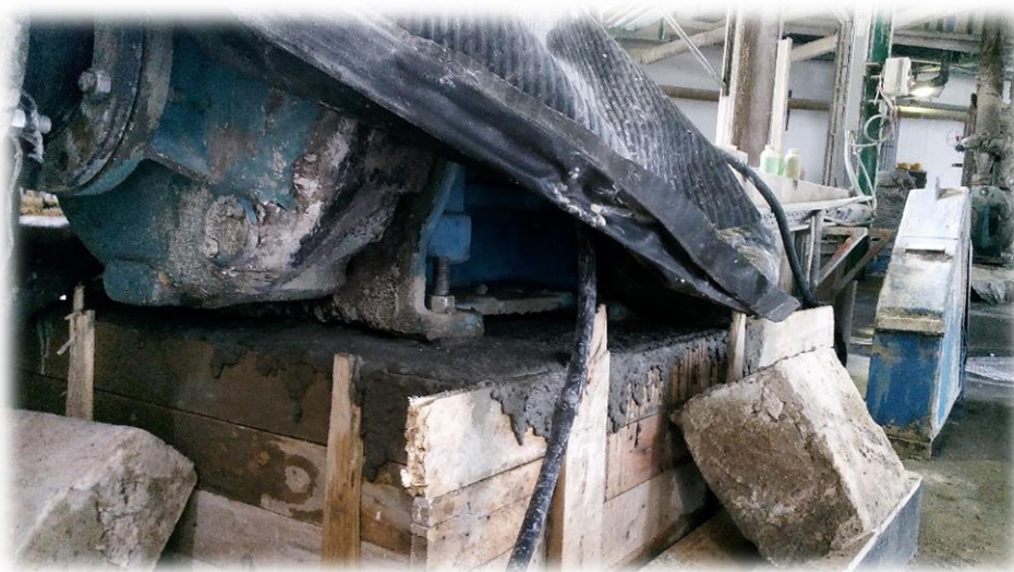
Figure 19 : Désalignement de l'arbre moteur-récepteur
