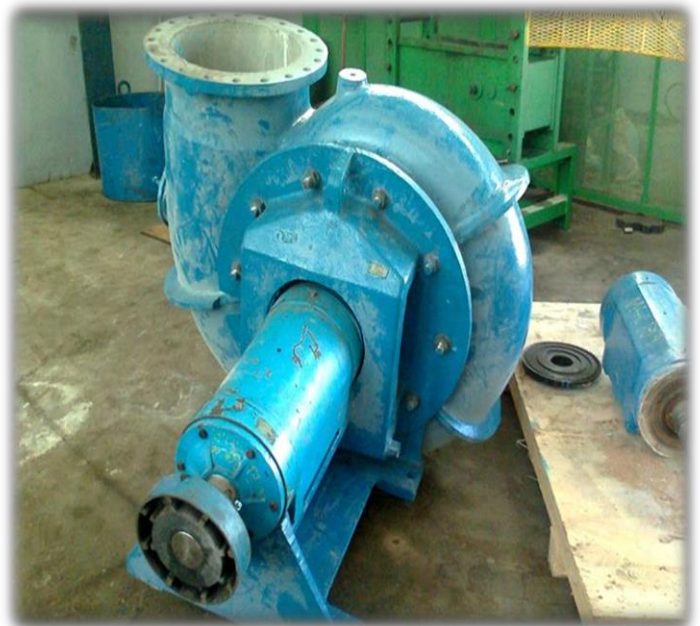
Figure 13 : Photo et caractéristiques de la pompe folwserve LC
