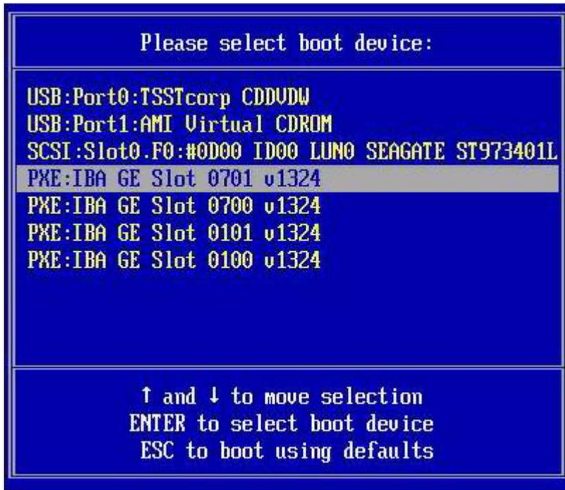
3. Dans le menu Please Select Boot Device (Sélectionnez un périphérique de démarrage), sélectionnez le périphérique de démarrage de l'installation PXE, puis appuyez sur Entrée.
