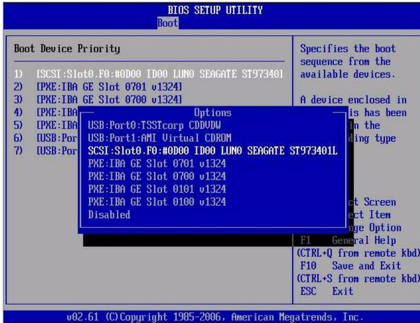
Les chaînes de périphérique répertoriées dans la boîte de dialogue Boot Device et l'onglet Options se présentent dans le format suivant : *type de périphérique, indicateur d'emplacement, chaîne d'ID de produit.*
