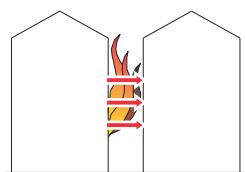
transmission par rayonnement d'un bâtiment à l'autre
