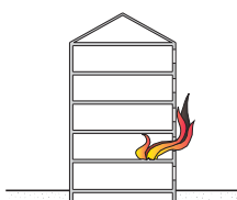
transmission d'un étage à l'autre par la façade à laquelle répond la règle du C + D
