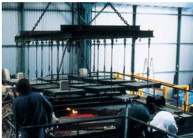
Essais de résistance au feu d'un plancher en béton sur four horizontal, par le laboratoire du Centre scientifique et technique du bâtiment (CSTB).
