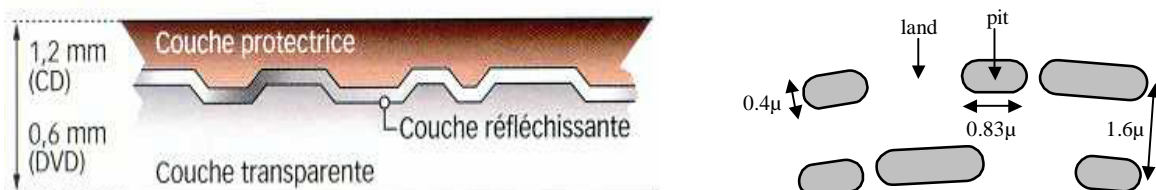
Fig. III.25 : coupe et vue de face d'un CD-ROM
