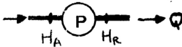
\*La puissance  $P_a$  absorbée par la pompe (en Joules/s ou en Watts) est égale au travail effectué par la pompe, pendant l'unité de temps, pour élever le débit d'eau  $Q$  (en  $m^3/s$ ) à une hauteur de refoulement  $H$  (en m).
