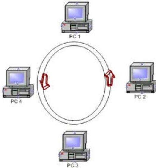
Les stations du réseau ne peuvent communiquer seulement quand elle possèdent le jeton. Le jeton est intercepté par la station qui souhaite émettre ou recevoir des trames. Une seule station peut donc "causer" dans le même laps de temps. En FDDI, il y a une deuxième boucle de secours au cas où la première boucle est temporairement inutilisable.
