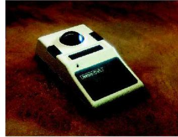
**Une souris est constituée d'une boule sphérique parfaitement libre de ses rotations à l'intérieur du boîtier que l'utilisateur tient dans la main et dans lequel elle est enchâssée.**
