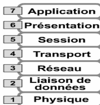
Figure 1: Modèle OSI
