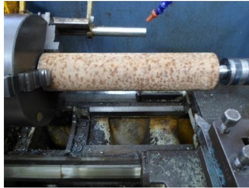
Figure 1: Montage de la pièce brute
