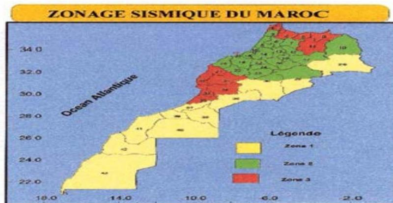
Figure 3.1 : Zonage sismique du Maroc
