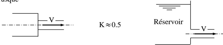
Pour réduire les pertes singulières, on doit éviter les angles vifs et les changements brusques de sections. La perte de charge totale entre deux points d'un circuit est :
