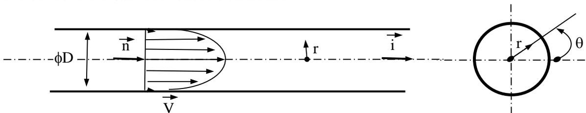
$$\vec{V} = V \cdot \vec{i} \quad V = f(r) = V_{\text{Max}} \left( 1 - \frac{r^2}{R^2} \right) \text{ avec } R = D/2$$
