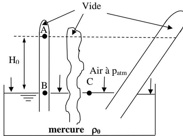
Le mercure dans le tube étant au repos, on applique la R.F.H. entre A et B
