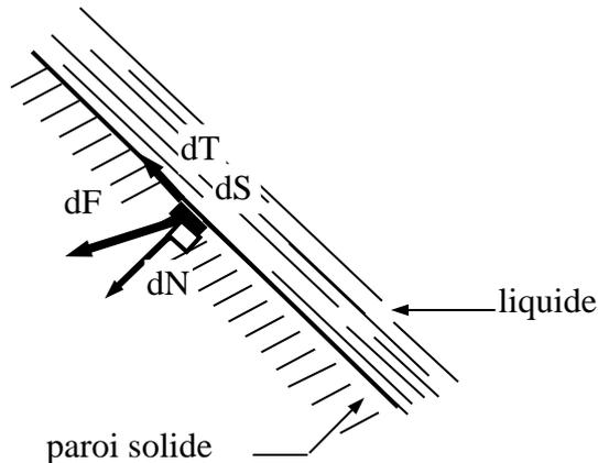
$dF$  : force exercée par le liquide sur l'élément de surface  $dS$
