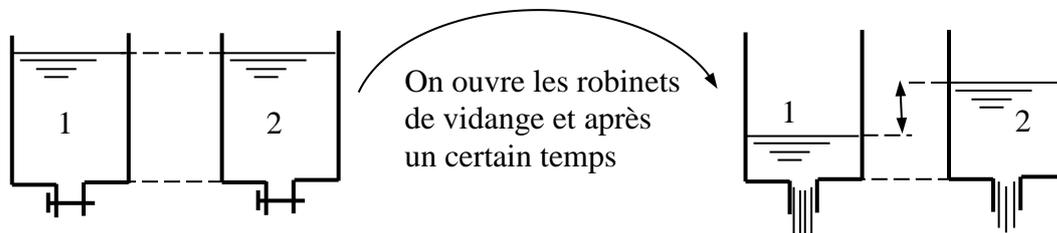
On constate que le liquide 1 se vide plus rapidement que le liquide 2. On dit que : la viscosité du liquide 1 est plus faible que celle du liquide 2, ou le liquide 1 est moins visqueux que le liquide 2.
