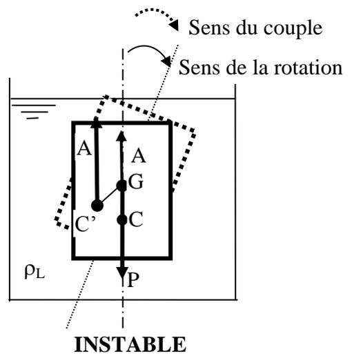
On fait dévier le solide d'un petit angle par rapport à G. Le centre de poussée change de position et passe de C à C'. Il se crée un couple (P, A). Si le couple tend à ramener le solide à sa position de départ, alors la position là où il a été est stable. Si le couple tend à l'écarté encore plus, alors la position est instable.
