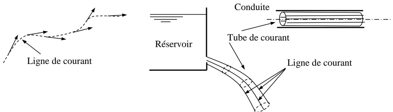
La trajectoire est le lieu géométrique des positions prises par une particule au cours de son mouvement. **En écoulement permanent Trajectoire = ligne de courant.**
