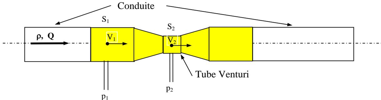
On suppose qu'il n'y a pas de perte d'énergie (fluide parfait pas de frottement) dans le tube de Venturi. On applique le théorème de Bernoulli entre les sections  $S_1$  et  $S_2$  du tube Venturi.
