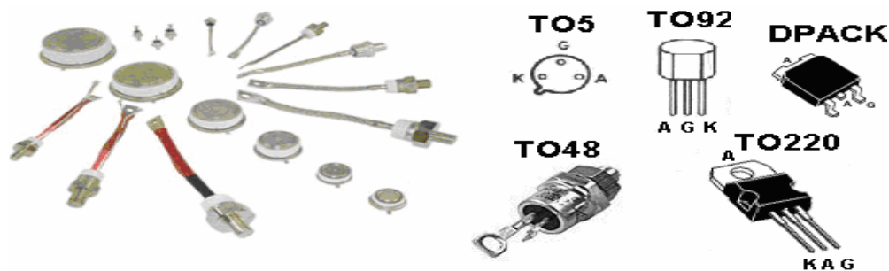
Figure 5. Différentes représentations des thyristors sur le marché
