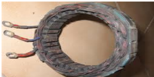
FIGURE 9.1 – Vue du stator d'un moteur asynchrone
