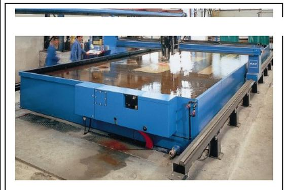
**Figure 70 - machine de coupage à programme numérique**
