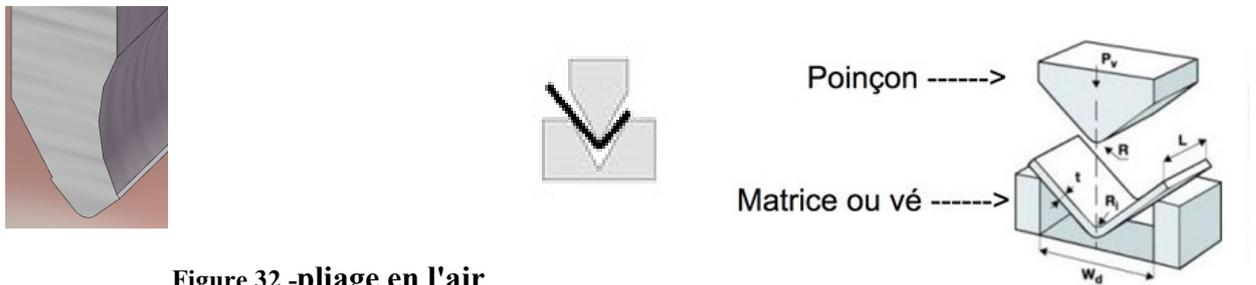
Figure 32 -pliage en l'air
