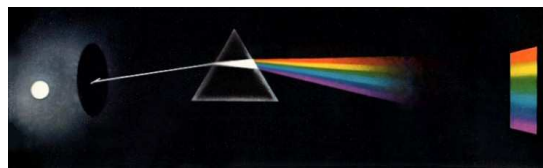
FIGURE 5 – Dispersion de la lumière du Soleil à travers un prisme : le spectre est continu.
