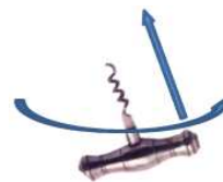
FIGURE 2 – Application du théorème de Stokes : la surface \Sigma s'appuie sur le contour \Gamma . Sa normale est orientée d'après la règle du tire-bouchon : on tourne le tire-bouchon dans le sens conventionnel d'orientation du contour \Gamma . Le sens global de déplacement du tire-bouchon donne le sens global de la normale à la surface.
