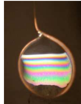
FIGURE 11 – (À gauche) Mise en évidence du phénomène d'interférence dans l'expérience des fentes d'Young. (À droite) Irisations dues au phénomène d'interférence sur une lame de savon.
