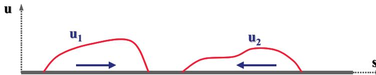
Figure 8.3 : Propagation longitudinale dans une barre
