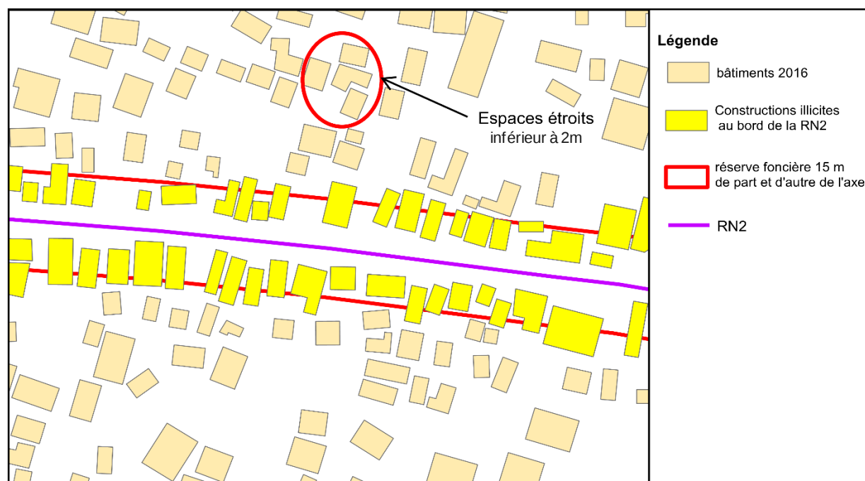
Figure 25 : Exemple des constructions illicites dans le Fokontany Antanambao
