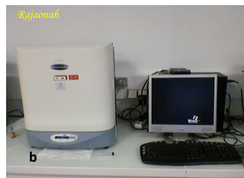
Photo 85 : Analyseur Li-Cor® 4300 ( a : emplacement du gel acrylamide ; b : l'appareil relié à l'ordinateur )
