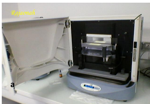
Photo 85 : Analyseur Li-Cor® 4300 ( a : emplacement du gel acrylamide ; b : l'appareil relié à l'ordinateur )
