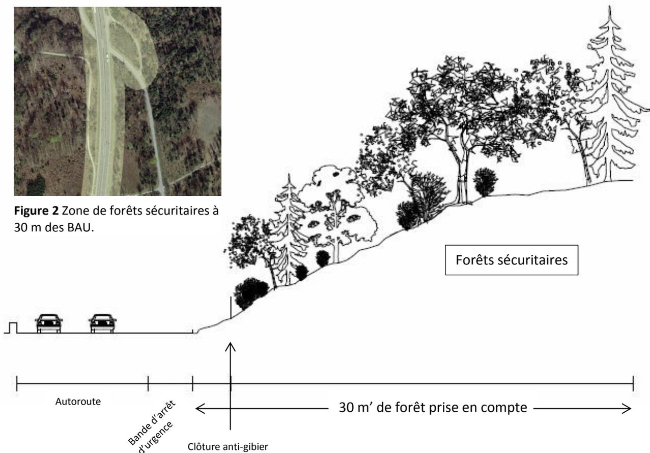
**Figure 3** Schéma illustrant la distance prise en compte pour les forêts sécuritaires.
