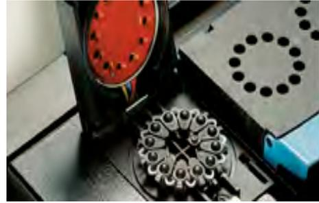
Figure : 12. Chargement des couronnes d'échantillons. Figure : 13 Couronne chargée dans le module d'amplification.
