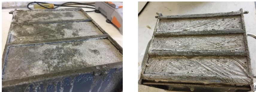
Figure 3. 10. Retrait à la surface des éprouvettes de mortier observé après 24 heures.
