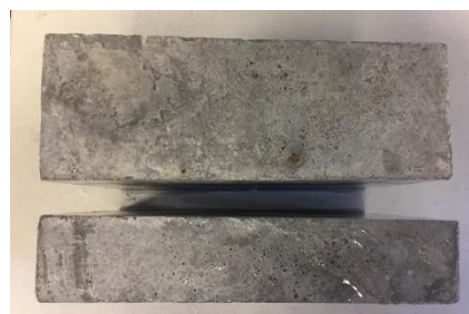
Figure 3. 11. Vue depuis le haut des éprouvettes à deux différentes dimensions (épaisseur 7 cm en haut et 4 cm en bas) après le démoulage.
