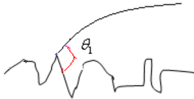
Figure II. 2 Une goutte sur une surface rugueuse éprouvant la rugosité
