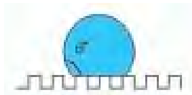
Figure II.17 : L'état de Cassie, le liquide repose sur le sommet des aspérités [17]
