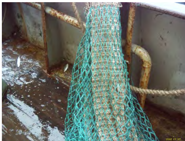
Figure 23: Ceinture de protection autour du cul de chalut (Source : MAP, 2006)
