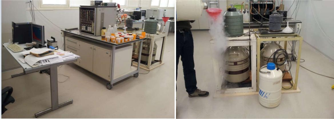
Figure 76 : Spectromètre coaxial gamma HPGe et accessoires de EG&G ORTEC Company
