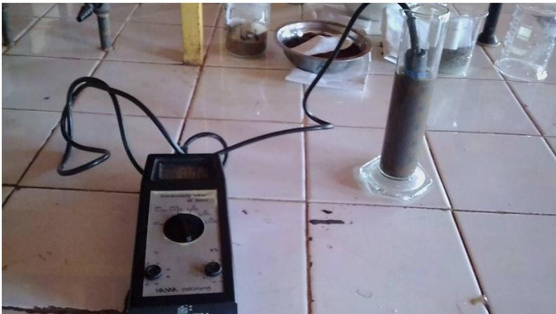
Figure.24a Conductimètre dans le tube à essai
