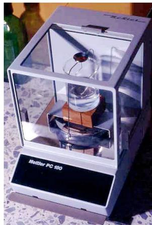
**Figure 35 : Mesure de densité des minéraux**
