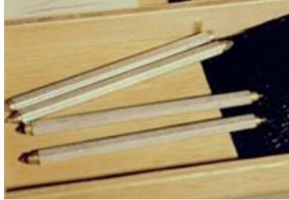
**Figure 37 : Tiges serties de minéraux pour la mesure de dureté comprise entre 5 et 9**
