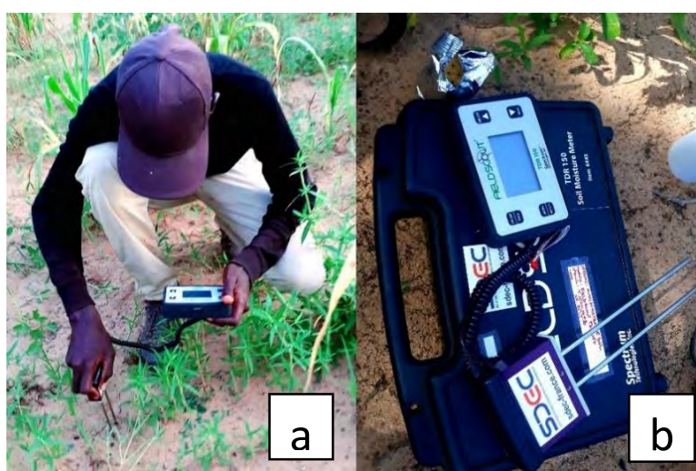
Figure 13 : Mesure de la teneur en eau et de la température du sol (a) à l'aide d'une sonde TDR (b)
