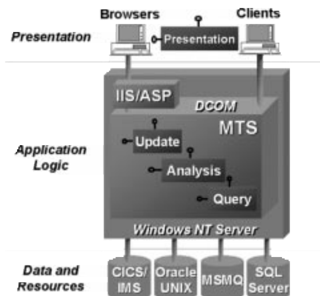
Figure 19 : Le modèle de composants COM/MTS
