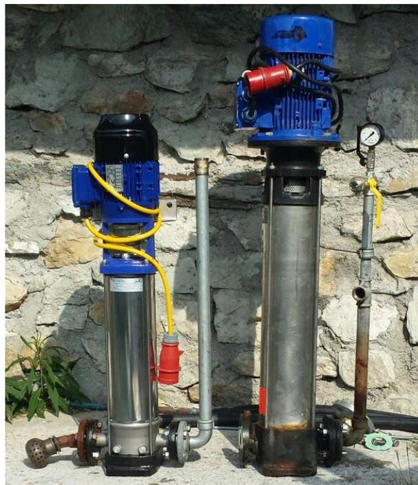
Figure 7: Nouvelle et ancienne pompe d'eau potable
