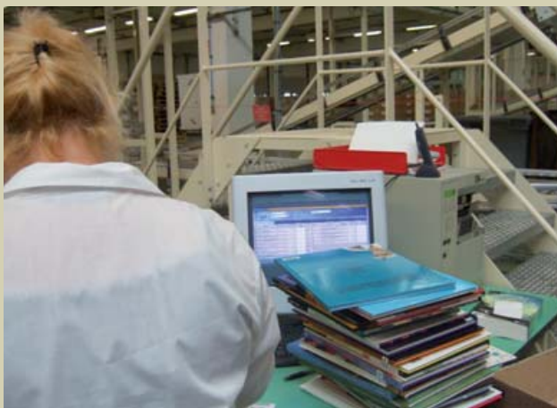
6. Contrôle pondéral. En fin de préparation, une balance pèse le colis pour comparer le poids réel au théorique. En cas d'écart significatif, chaque livre est scanné pour voir d'où vient l'erreur.
