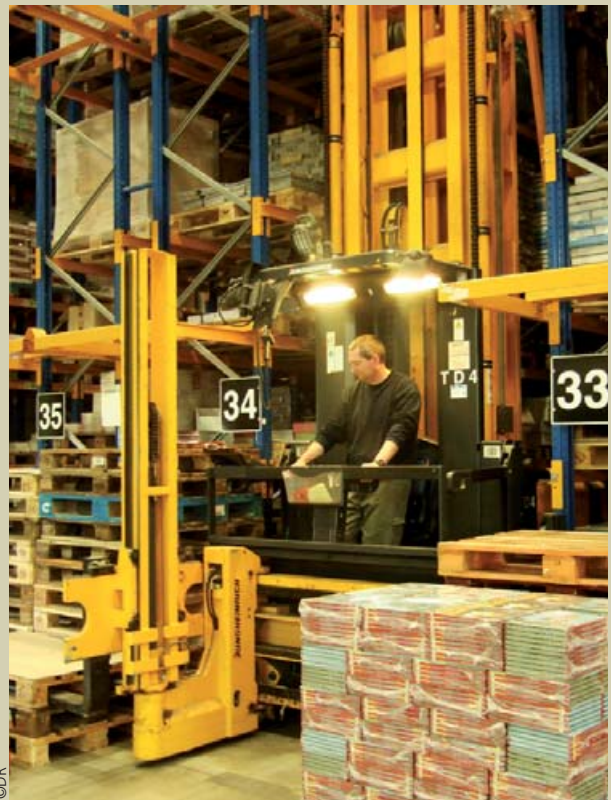
2. Rangement. Embarqués dans des chariots tri-directionnels filoguidés, les caristes rangent les palettes déchargées des camions dans le palettier de 36.000 emplacements. Equipés en radiofréquence, ils réalisent des inventaires tournants et prélèvent palettes et colis pour réapprovisionner les zones de préparation (environ 1.000 réapprovisionnements par jour).
