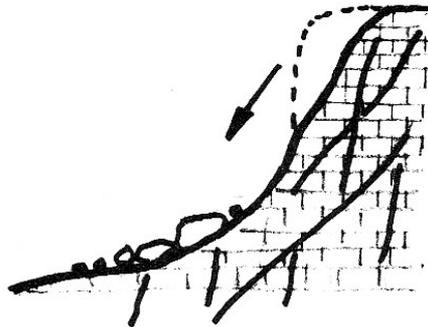
Fig. 1 : Écoulement rocheux par dislocation interne
