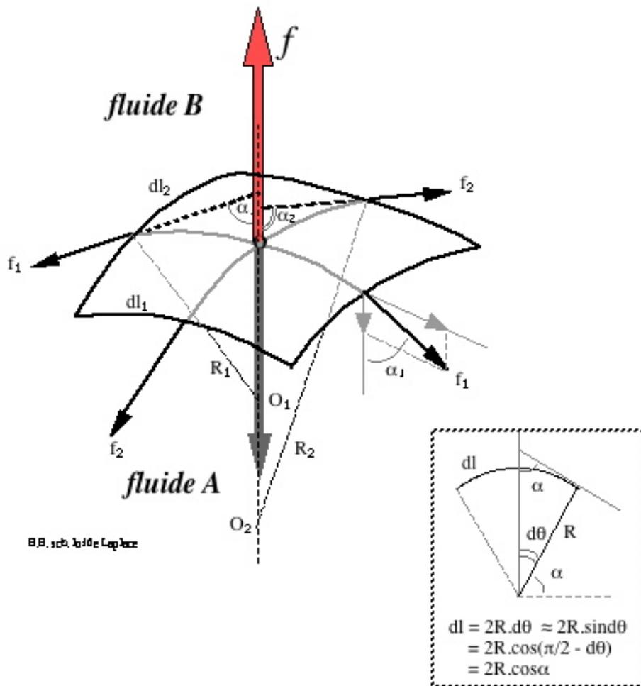
Surface S (séparation fluide A / fluide B) limitée par côtés  $dl_1$  et  $dl_2$ , arcs de cercle de centre  $O_1$  et  $O_2$ , de rayon  $R_1$  et  $R_2$
