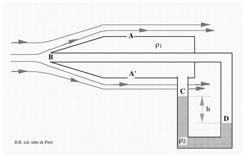
**Résolution caractéristique via l'exemple du tube de Pitot**
