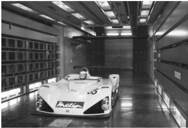
FIGURE 4.30: Étude aérodynamique d'une voiture de compétition. Photo de la soufflerie S4 de l'Institut AéroTechnique du CNAM (Une balance à 6 composantes, est disposée sous le plancher de la chambre d'expériences. Le véhicule à qualifier repose sur ses roues, sur quatre patins de forme rectangulaire affleurant le plancher et liés au bâti mobile de la balance. Trois dynamomètres à jauges de contraintes, dont les axes de mesure sont dirigés perpendiculairement au plancher, transmettent les poussées verticales à des butées hydrostatiques. Trois autres dynamomètres répartis dans un même plan horizontal et orientés suivant des directions orthogonales privilégiées, sont utilisés pour déterminer les composantes horizontales du torseur des efforts.).
