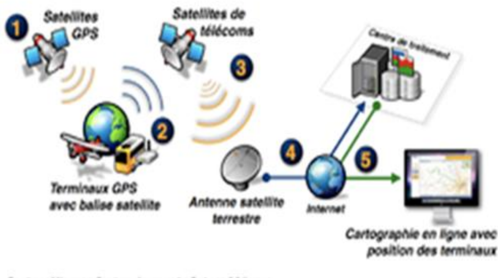
Figure N ° 12: Architecture d'un système de géolocalisation par G.P.S avec remontée des données via le réseau satellite
