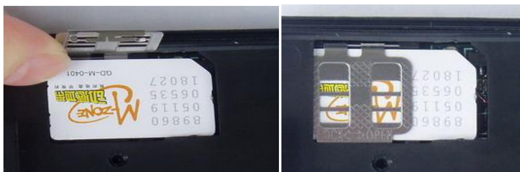
Figure N° 36 : Insertion de carte SIM dans le support
