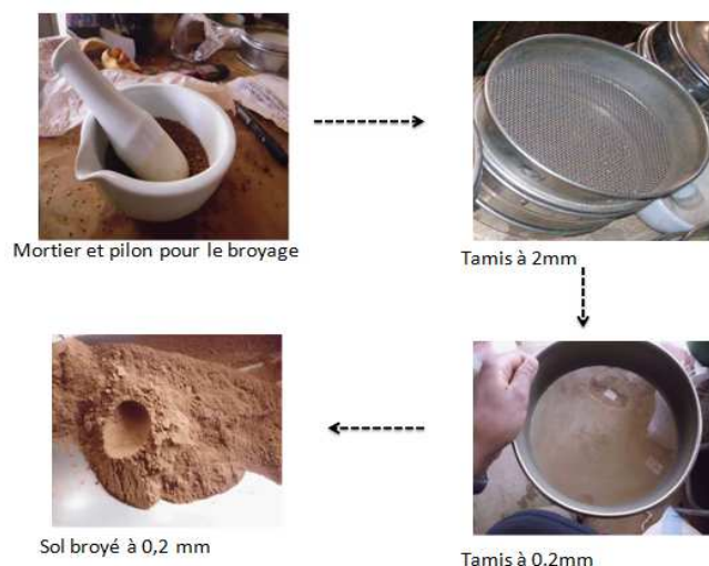
Photo 2: Matériels utilisés lors du broyage des sols
