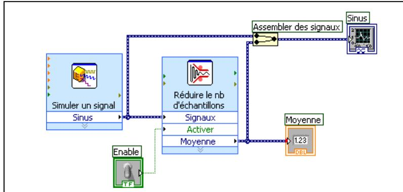
**Figure 2-3.** Diagramme du VI Réduire le nombre d'échantillons
