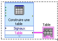
3. Si le VI Express Construire une table et le terminal **Table** ne sont pas déjà sélectionnés, cliquez sur un espace vide du diagramme, à gauche du VI Express et du terminal **Table**. Faites glisser le curseur en diagonale jusqu'à ce que le rectangle de sélection englobe le VI Express Construire une table et le terminal **Table**, comme illustré à gauche.
