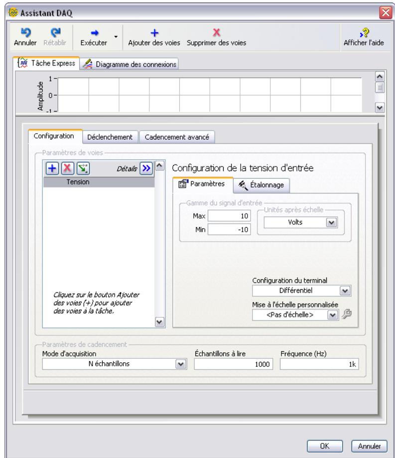
Figure 4-1. Configuration d'une tâche avec l'Assistant DAQ
