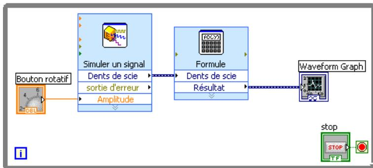
Figure 1-8. Diagramme du VI Acquéirir un signal
