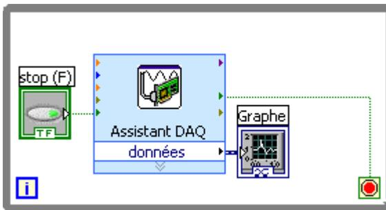
Figure 4-2. Diagramme du VI Lire une tension
