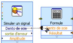
Examinez les fils de liaison reliant les VIs Express aux terminaux. Les flèches des terminaux et des VIs Express indiquent la direction dans laquelle les données circulent sur ces fils. Le diagramme devrait maintenant ressembler à la figure 1-8.
