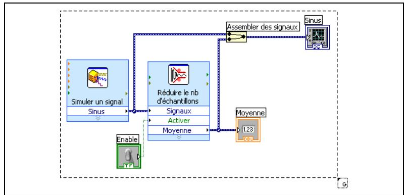
Figure 2-4. Placement de la boucle While autour des VIs Express
