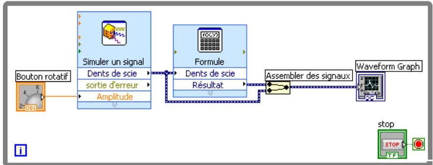
Figure 1-9. Diagramme représentant la fonction Assembler des signaux
