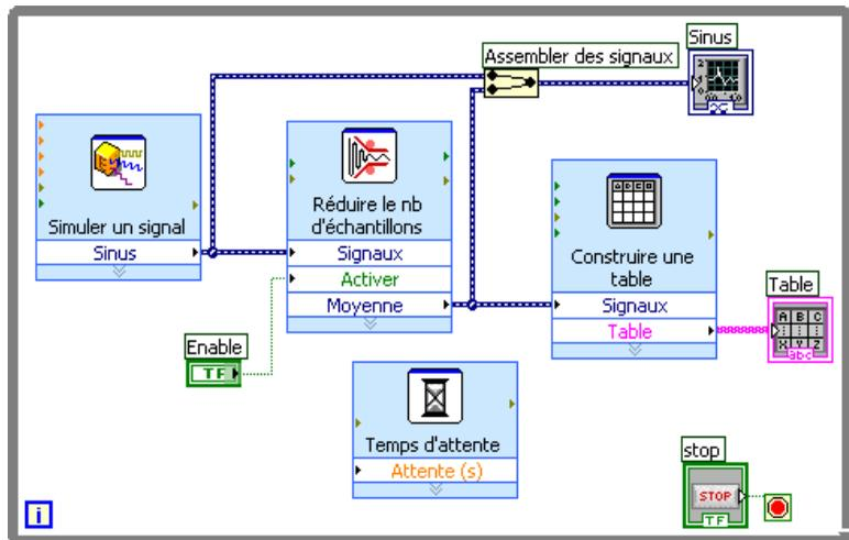
Figure 2-5. Diagramme du VI Réduire le nombre d'échantillons
