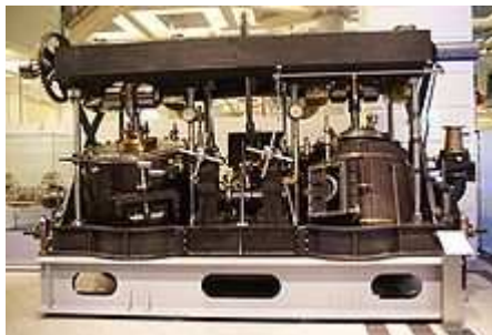
Oscillant d'un navire à vapeur cylindre, construit 1853.
