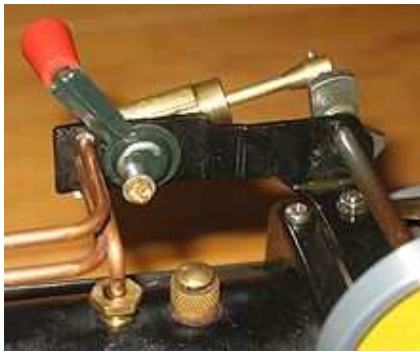
Un cylindre oscillant réversible
