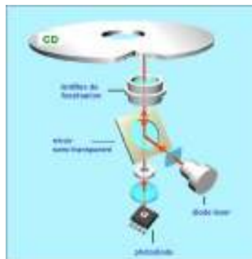
Fig. 6. Système optique de lecture par réflexion
