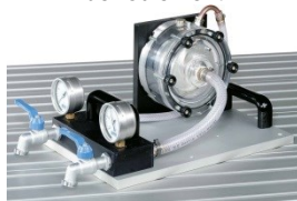
Cavitation dans les pompes
