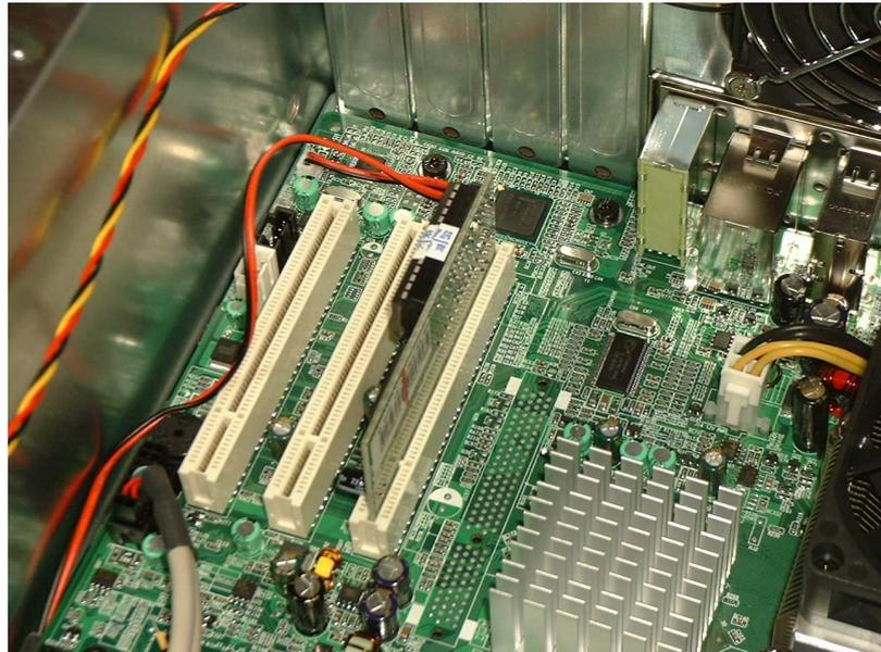
Comme on peut l'apercevoir sur l'image ci-dessus, la carte ne dépasse pas à l'extérieur de l'ordinateur et prend un emplacement PCI. Lorsque l'installation matérielle de la carte est terminée, il faut démarrer l'ordinateur pour effectuer l'installation logicielle de la carte. Cette phase d'installation est obligatoire.
