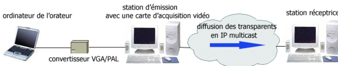
**Figure 16 :** Transmission des transparents en multicast.
