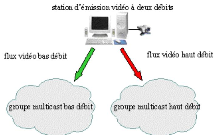
**Figure 20** : schéma de principe du Vic à deux vitesses.
