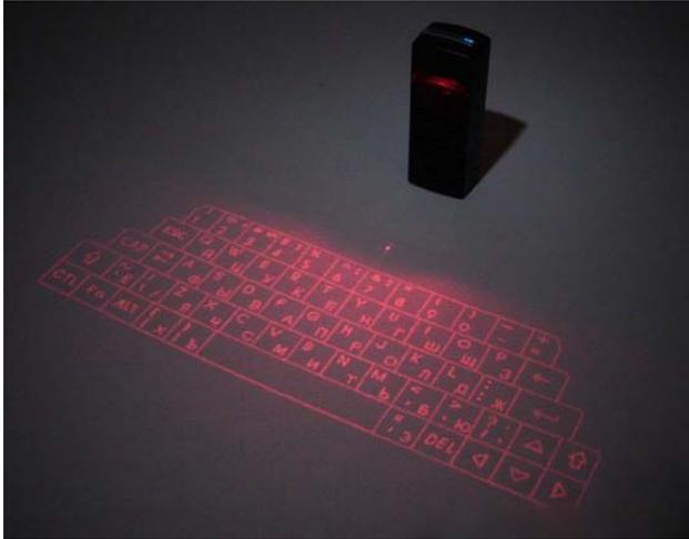
Développé dans les années 80 par la société QUINTEL afin d'améliorer la fiabilité de la frappe et sécuriser l'information en conservant la technologie keyroll over des claviers rapides. Le principe du clavier optique réside dans la détection de l'enfoncement d'une touche par l'interruption d'un faisceau lumineux.
