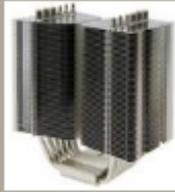
Egalement appelé aircooling, il est le principe de refroidissement le plus utilisé. Ils sont simples à mettre en place, suffisamment efficaces dans la majorité des cas, économiques et ne sont en rien dangereux. Il est dit passif car aucune pièce mécanique n'est en mouvement. Un simple dissipateur (un radiateur) est fixé sur le composant à refroidir, afin d'augmenter la surface de contact avec l'air ambiant, et donc de faciliter la dissipation thermique.
