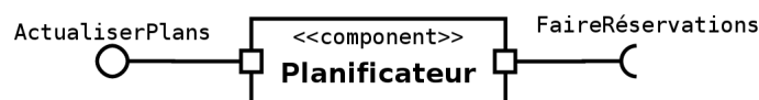
FIG. 8.4 – Représentation d’un composant et de ses interfaces requise et offerte avec la représentation explicite de leur port correspondant.
