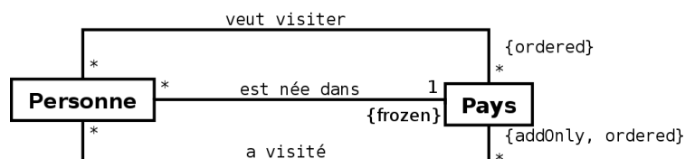
FIG. 4.2 – Ce diagramme exprime que : une personne est née dans un pays, et que cette association ne peut être modifiée ; une personne a visité un certain nombre de pays, dans un ordre donné, et que le nombre de pays visités ne peut que croître ; une personne aimerait encore visiter tout une liste de pays, et que cette liste est ordonnée (probablement par ordre de préférence).
