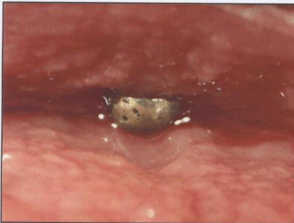
**Figure 19. Aspect sous loupe binoculaire X16 d'une bille d'acier après congélation**
