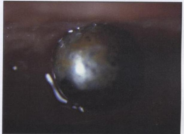
**Figure 20. Aspect sous loupe binoculaire X40 d'une bille d'acier après congélation**
