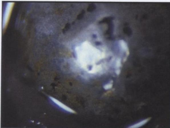
**Figure 21. Aspect sous loupe binoculaire X16 d'une bille d'acier témoin**
