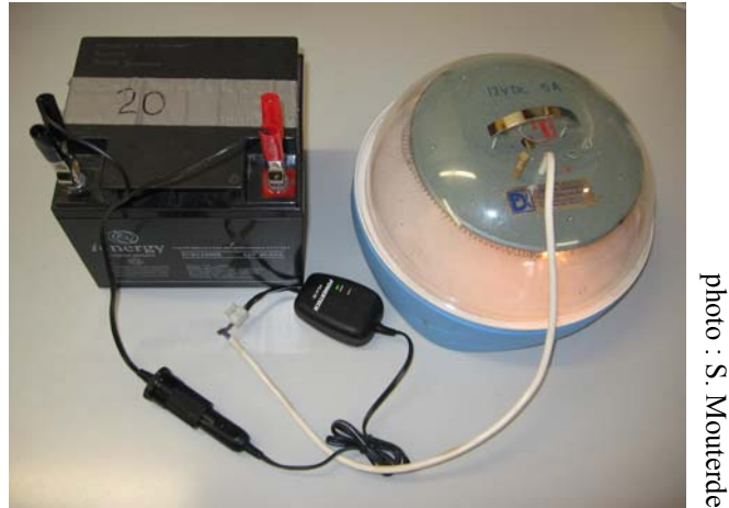
Figure 27 : Incubateur portatif et sa batterie
