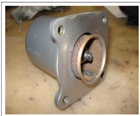
Figure 44 : le carter et son filtre démonté
