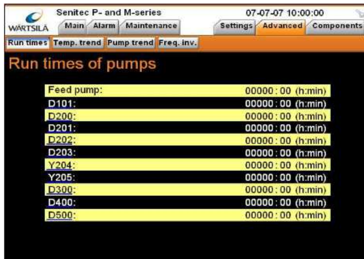
Figure 24: Visualisation du temps de fonctionnement des pompes
