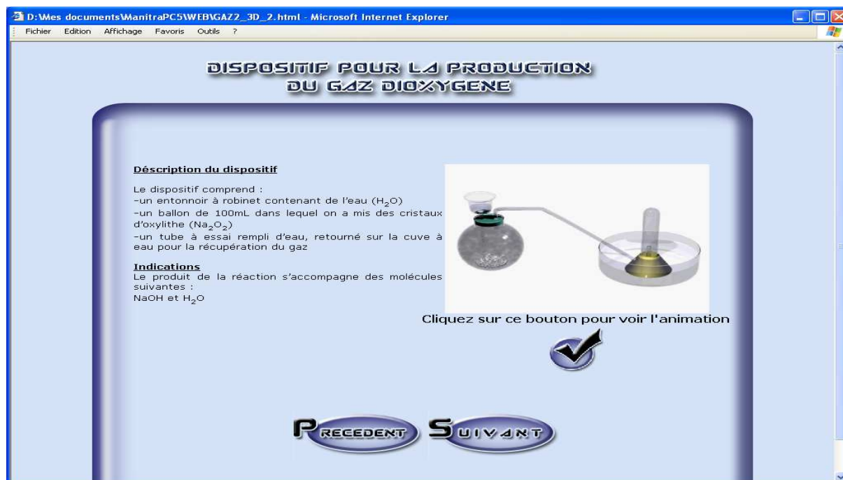
Figure 42 : Phase de la production du dioxygène
