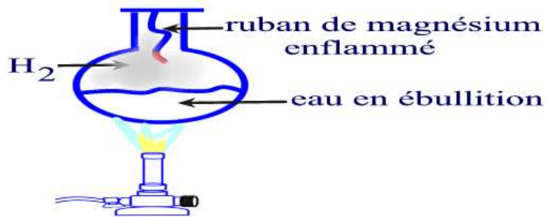
Figure 14 : Réduction de l'eau par le magnésium
