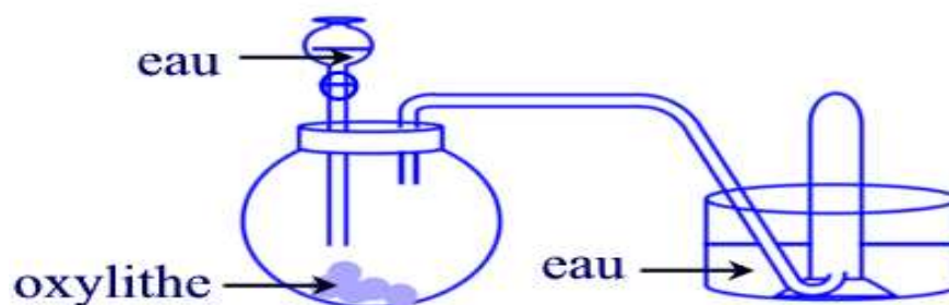
Figure 60 : Montage pour la production du gaz O_2
