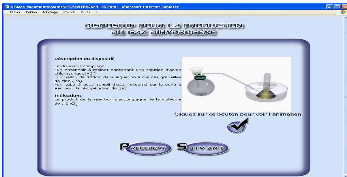
Figure 51 : Présentation du dispositif de production du dihydrogène
