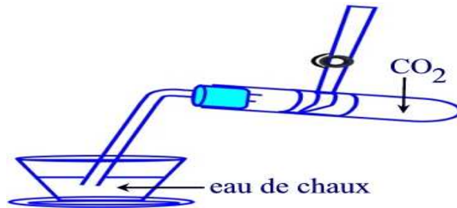
Figure 63 : Montage pour le test du gaz CO 2
