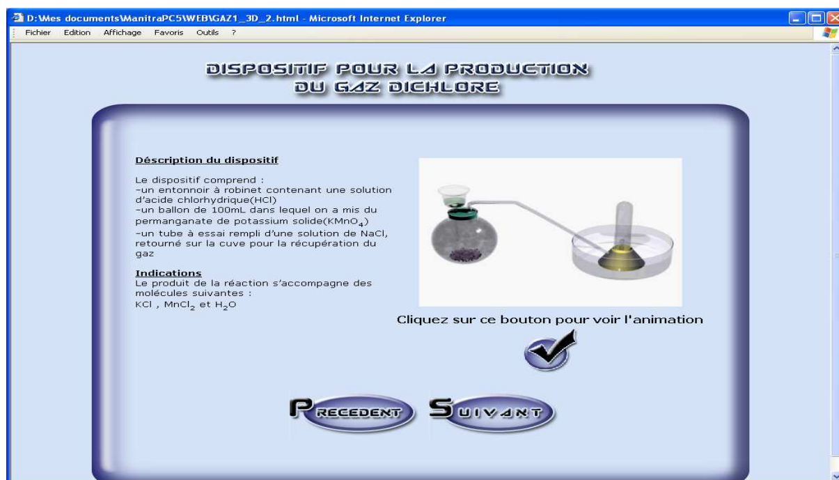
Figure 37 : Phase de la production du dichlore
