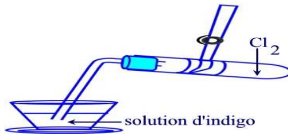
Figure 59 : Montage pour le test du gaz \text{Cl}_2
