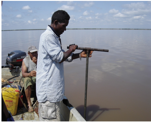
Photo 5 : Prélèvement de sédiments du lac à l'aide d'un carottier
